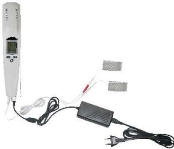
Nel caso si desideri utilizzare il dispositivo in modalità elettroterapia TENS, collegare il cavo con due terminali al connettore (8).
